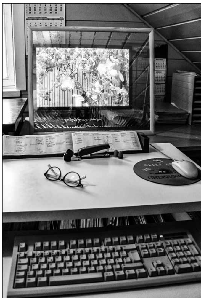
Kaijan Työpiste sijaitsee talon yläkerrassa. Tietokoneen näyttö on asetettu maadoitettuun pistorasiaan. Näytön edessä on suojalevy, joka vaimentaa sähkökenttää ja RF-taajuuksia. Näppäimistö ja hiiri toimivat johdollisina.
