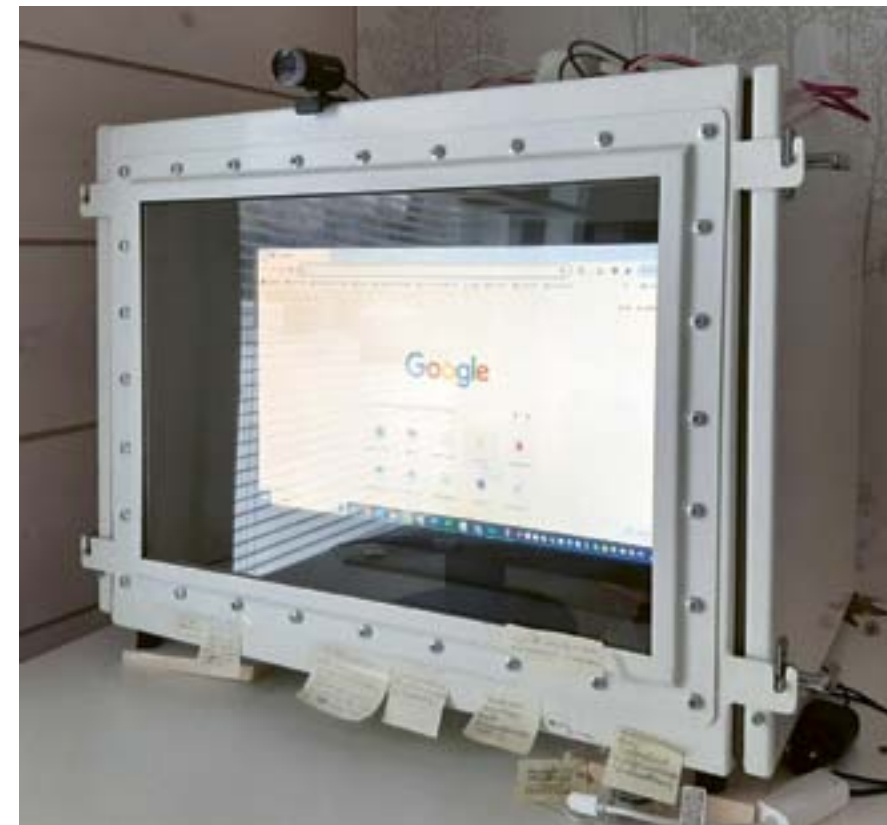
Kuvassa suo- jakaappi ja sen sisällä oleva näyttö.
